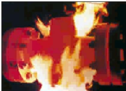
压力平衡式旋塞阀的设计符合 API 6FA 标准防火安全要求，并取得了 API 6FA 防火证书。
